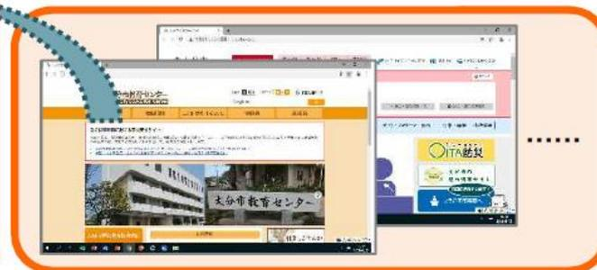
※サーバ上で仮想的に稼働するブラウザを通してインターネットにアクセスし、画面情報のみを校務端末に転送する。端末では画面情報を操作するだけなので、端末側にウィルスが侵入することはない。
